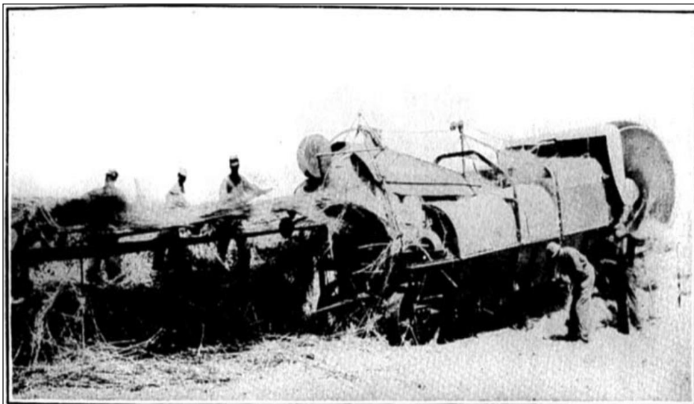
Şekil 8. Kenevir kırma makinesi. Saplar, 2 ila 3 inç kalınlığında sürekli bir tabaka halinde yanlamasına beslenir ve günde yaklaşık 4.000 pound temiz lif ve beş kat daha fazla hurda elde edilir.
